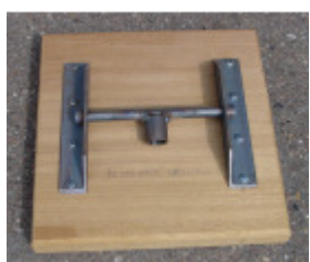
Asphalt-Glätter mit Halter aus schwerem Hartholz Abmessungen: 350 x 350 x 50 mm
